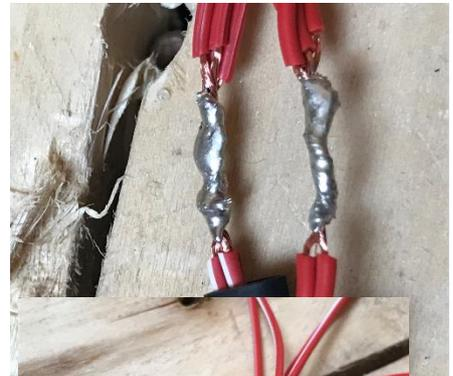
Danach können die Schrumpfschläuche mit einem Heißluftföhn oder Feuerzeug erhitzt werden und die Kabel sind zuverlässig verbunden!
