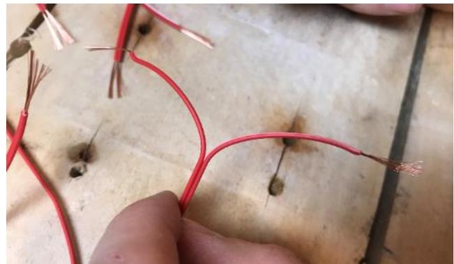
Anschließend werden die Litzen von einer Seite (Europa, Afrika und Australien) miteinander verdrillt. Das gleiche auch für die restlichen Kabel (Nord- und Südamerika, Grönland und das zusätzliche Kabel!). Dann könnt ihr gleich den Schrumpfschlauch mit dem größeren Durchmesser aufschieben.
