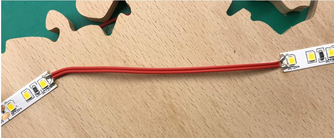
Diese Schritte dann so oft wiederholen bis alle Streifen miteinander verbunden sind. Um die Kontinente später in einem Stromkreis zu verbinden, muss noch an jedem Kontinent ein Kabel angelötet werden (Netzteil Kabel lt. Verkabelungsplan)
